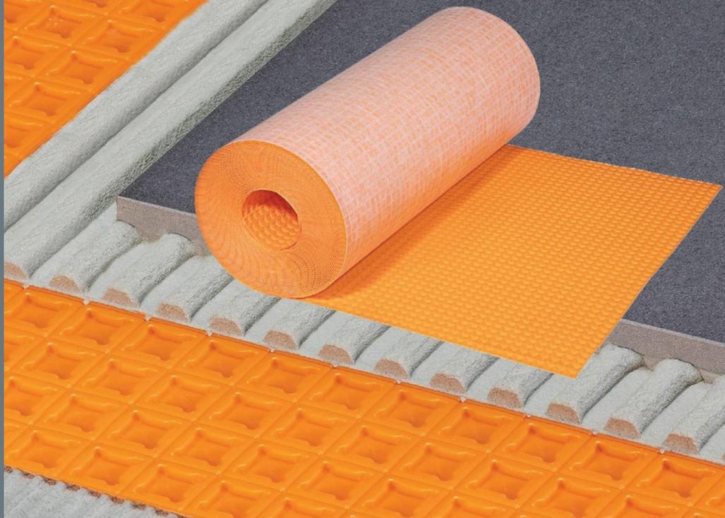
Материал представляет собой фактурное объемное полотно с углублениями сложной формы, в поперечном разрезе имеющими вид «обратного ласточкина хвоста». Полотно состоит из двух слоев – полипропилена высокой плотности и тонкого флиса, приклеенного термическим способом к нижней стороне мембраны и обеспечивающего высокую степень адгезии к плиточным клеям.
