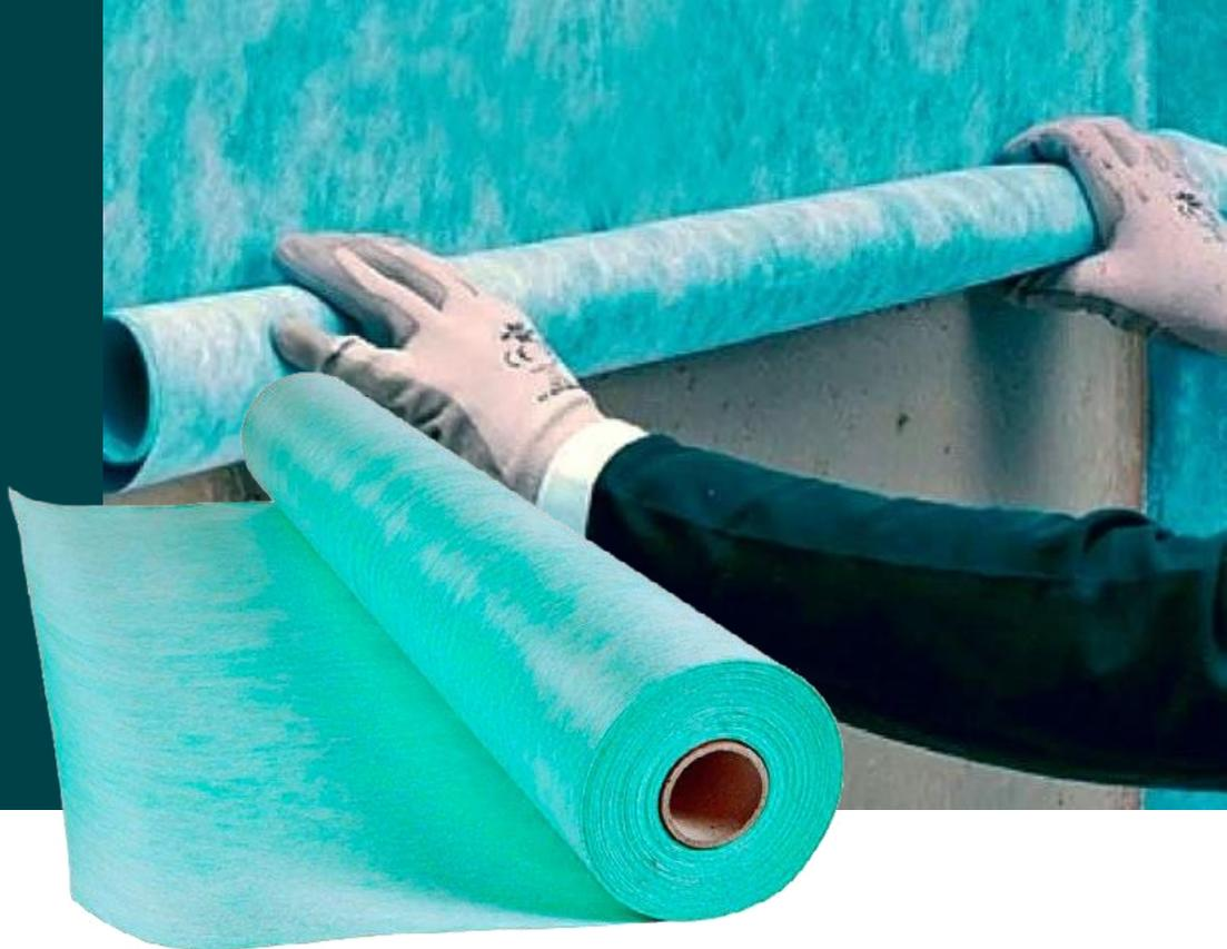
Трехслойная гидроизоляционная мембрана из полиэтилена и полипропилена с ворсистой поверхностью с двух сторон. Предназначена для подготовки вертикальных и горизонтальных поверхностей под облицовку плиточными покрытиями с одновременной гидроизоляцией в помещениях с повышенной влажностью. Способна перекрывать горизонтальные трещины шириной до 1 мм.
