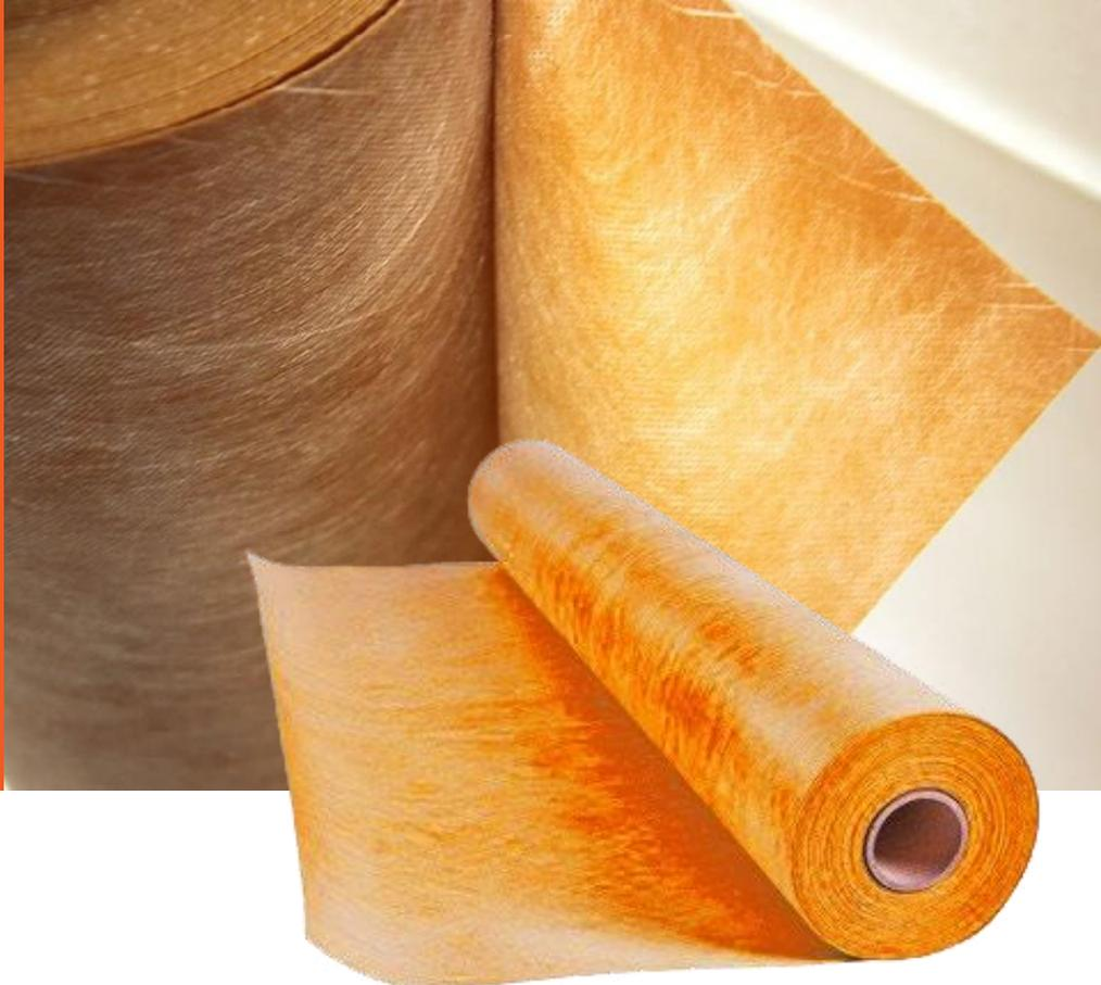
Гидроизоляционный материал нового поколения, обеспечивающий быструю и надежную гидроизоляцию в помещениях с повышенной влажностью, в т. ч. на поверхностях с трещинами шириной до 1,5 мм. Представляет собой тонкое полотно из полиэтилена высокой прочности с двухсторонним покрытием нетканым материалом, который обеспечивает высокую адгезию к плиточным клеям.
